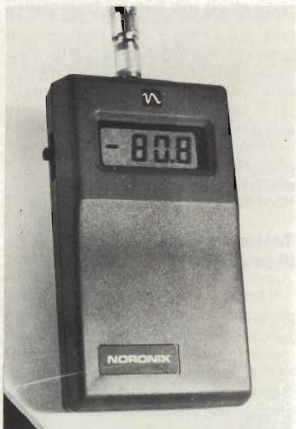
Termometro per termoresistenze con campo di lettura -100°C +199°C.
