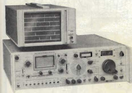
Fig. 1 - Ricevitore altamente professionale per la gamma delle microonde 30 MHz ÷ 18 GHz (estendibile a 40 GHz), modello MSR 903-1+2+7+(10S-1) della MICRO-TEL CORPORATION (ing. Vianello).
